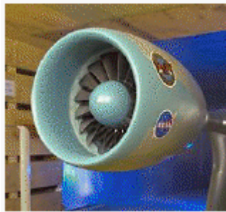
Υποηχητικός Αγωγός Εισόδου σε κινητήρα αεροσκάφους
