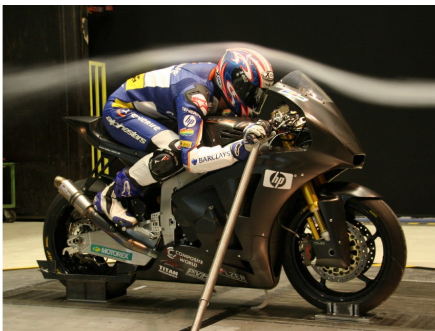
Σχήμα 2.1: Αγωνιστικό δίτροχο μηχανοκίνητο όχημα και αναβάτης σε αεροδυναμική σήραγγα.[8]
