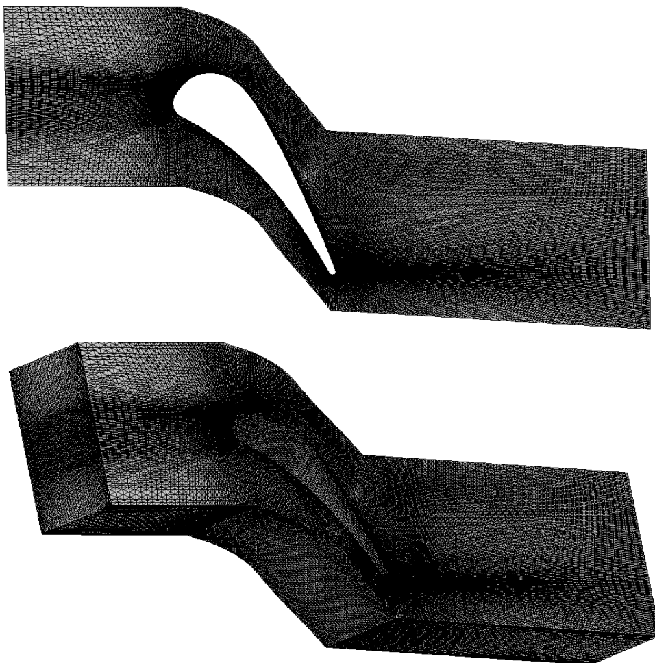
Σχήμα 4.8: 3Δ πτερύγωση στροβίλου C3X και μέσα σε αυτήν υπολογιστικό χωρίο 1828478 κόμβων και 8819840 τετραεδρικών στοιχείων.
