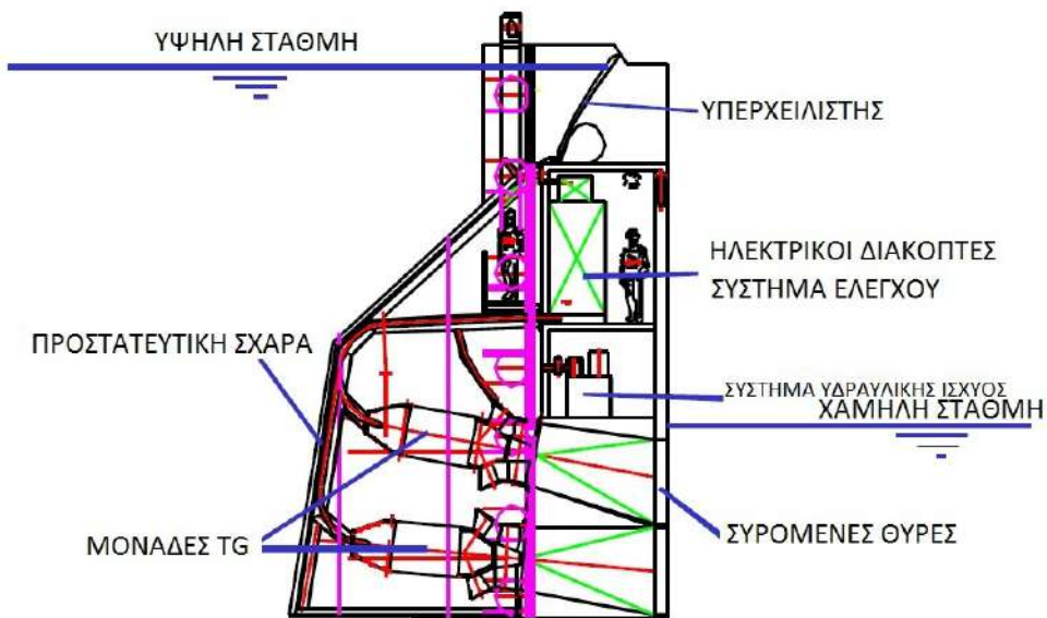
Σχήμα 3.6: Διάταξη πλέγματος υδροστροβίλων δυο σειρών[43].
