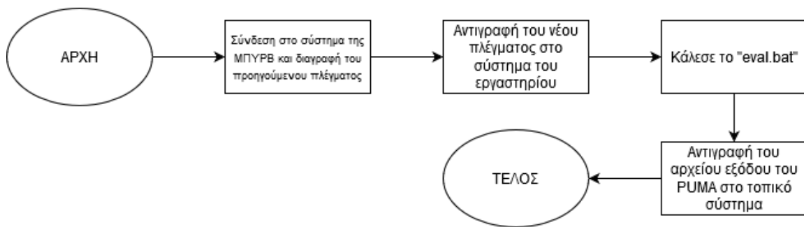
Σχήμα 4.5: Το διάγραμμα ροής του script "remote.bat"
