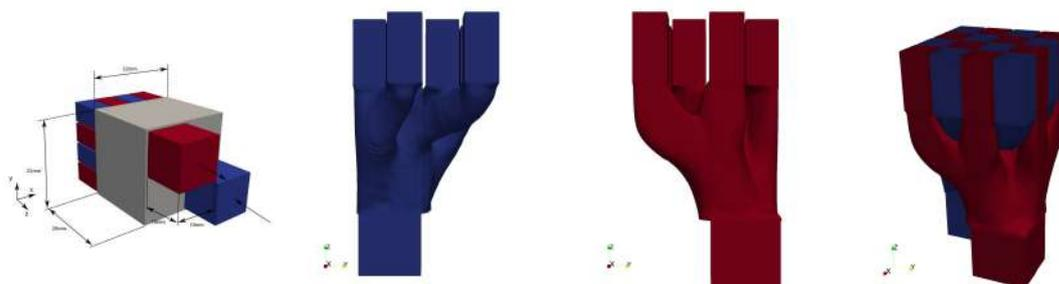
**Σχήμα 16:** ΒεΤο τριδιάστατου εναλλάκτη θερμότητας δύο ρευστών μιας εισόδου και οκτώ εξόδων για κάθε ρευστό. Υπολογιστικό χωρίο (αριστερά), προκύπτον τοίχωμα FSI πολλαπλής ψυχρού (μέση μπλε) και θερμού (μέση κόκκινο) ρευστού από την εφαρμογή της μεθόδου. Ολόκληρος ο εναλλάκτης (δεξιά).
