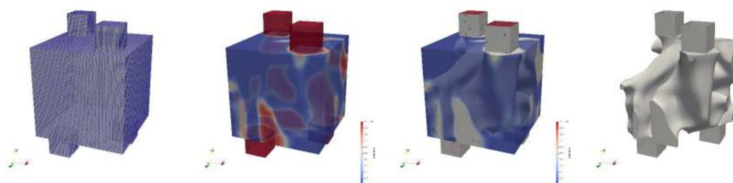
**Σχήμα 15:** ΒεΤο τριδιάστατου εναλλάκτη θερμότητας δύο ρευστών μιας εισόδου και μιας εξόδου για κάθε ρευστό. Υπολογιστικό χωρίο (αριστερά), πεδίο πορώδους (μέση) και προκύπτον τοίχωμα FSI από την εφαρμογή της μεθόδου.
