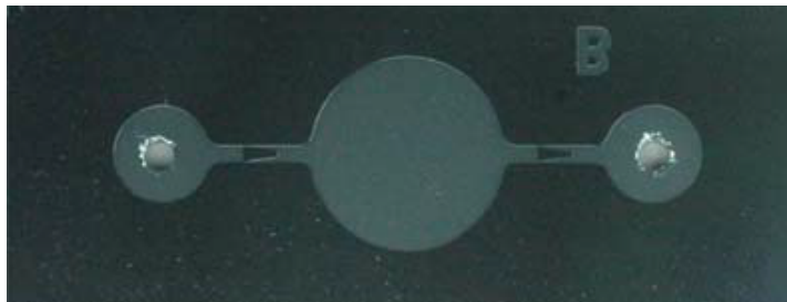
Σχήμα 1.7: Διαφραγματική μικρο-αντλία με αγωγούς σταθερής ορθογωνικής διατομής που φέρουν ασύμμετρα ως προς το θάλαμο εμπόδια, αριστερά διακρίνεται ο αγωγός εισόδου και δεξιά ο αγωγός εξόδου. Τα εμπόδια είναι σχεδιασμένα έτσι ώστε να διορθώνουν την αντιστροφή της ροής [12].
