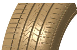
Σχήμα 9: Αποτέλεσμα τρι-διάστατης σάρωσης του ανάγλυφου ελαστικού.
