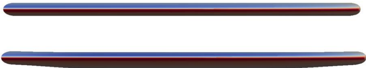
Σχήμα 36: Η βελτιστοποίηση σχήματος μεταξύ 1ου (πάνω) και 100ου (κάτω) κύκλου στο μπροστινό μέρος της πτέρυγας.
