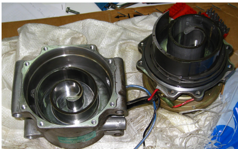
Σχήμα 3.3: Πραγματική μηχανή Scroll. Στα αριστερά διακρίνεται ο στάτης και στα δεξιά ο δρομέας.
