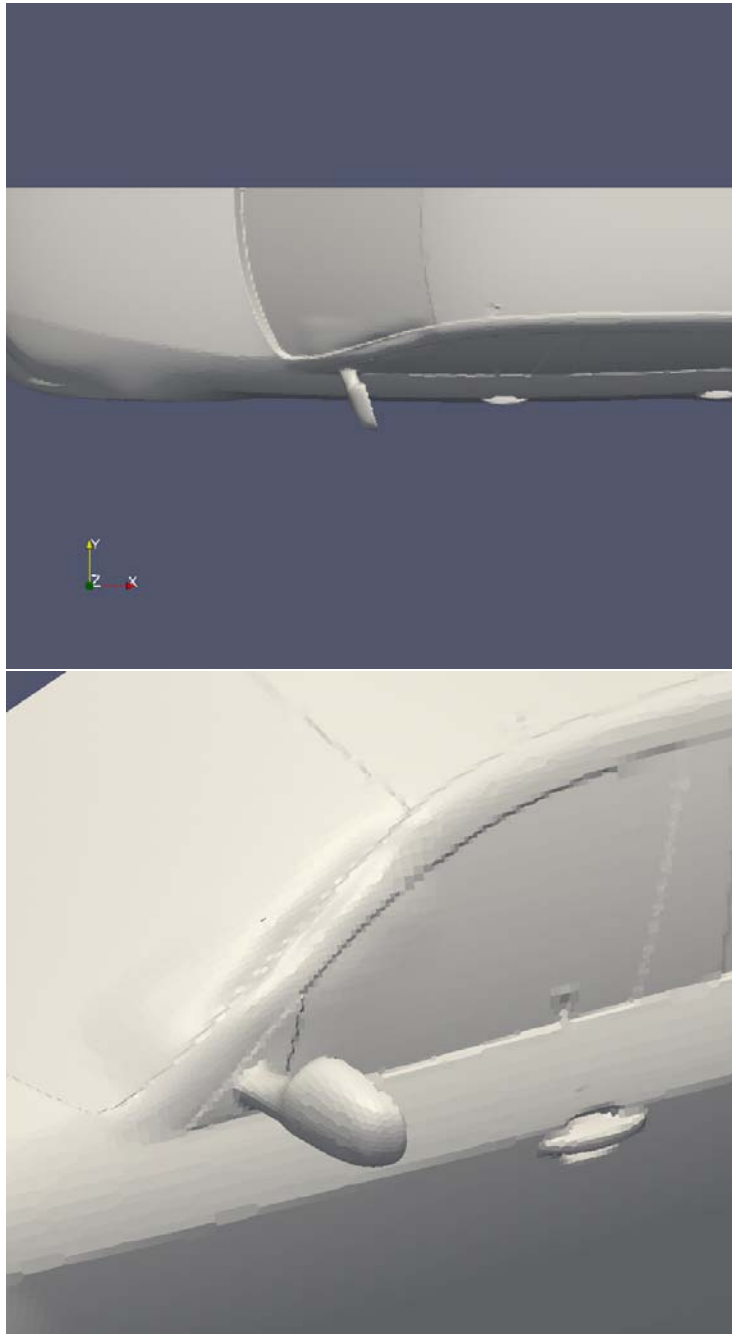
Σχήμα 5.15: Αποτέλεσμα της χρήσης του αρχικού πλέγματος ελέγχου. Τα παράθυρα έχουν παραμορφωθεί μαζί με το A-pillar, αποτέλεσμα ανεπιθύμητο. Για καλύτερη εποπτεία του προβλήματος έχει δοθεί στα σημεία ελέγχου μεγαλύτερη δυνατότητα μέγιστης μετακίνησης, ωστόσο το πρόβλημα παραμένει ακόμα και για μικρότερες τιμές μέγιστης μετατόπισης.
