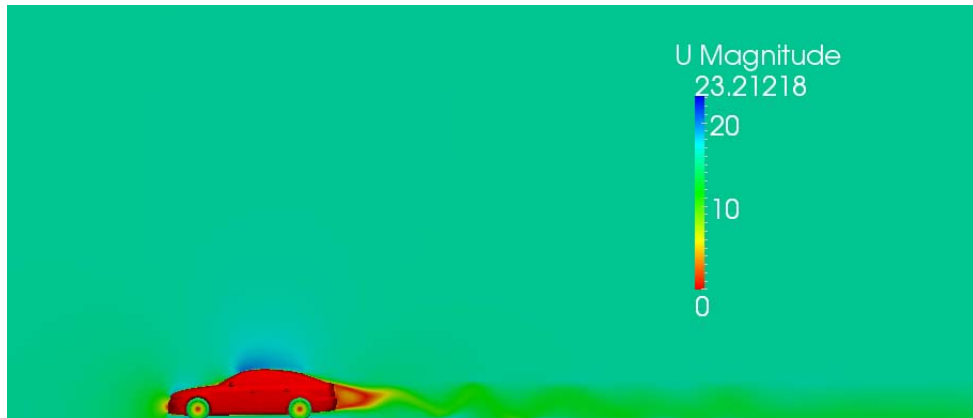
Σχήμα 3.3: Στιγμιότυπο της ταχύτητας για τη διαμόρφωση F\_S\_wM\_wW κατά την τελευταία επανάληψη του αλγορίθμου, για την περίπτωση των περιστρεφόμενων τροχών. Το μοντέλο τύρβης είναι το k - \omega SST και η διακριτοποίηση του όρου μεταφοράς είναι πρώτης τάξης.
