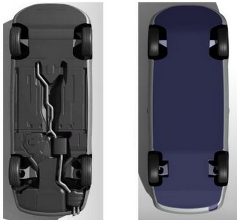
Σχήμα 1.3: Διαφορετικές διαμορφώσεις του DrivAer για το κάτω μέρος του αμαξώματος: Detailed Underbody (D) , Smooth Underbody (S) . Προσφορά του Τεχνικού Πανεπιστημίου του Μονάχου [11].
