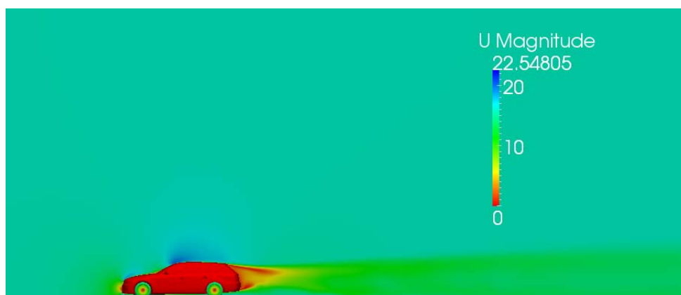
Σχήμα 3.4: Στιγμιότυπο της ταχύτητας για τη διαμόρφωση E_S_wM_wW κατά την τελευταία επανάληψη του αλγορίθμου, για την περίπτωση των περιστρεφόμενων τροχών. Το μοντέλο τύρβης είναι το k-\omega SST και η διακριτοποίηση του όρου μεταφοράς είναι πρώτης τάξης.
