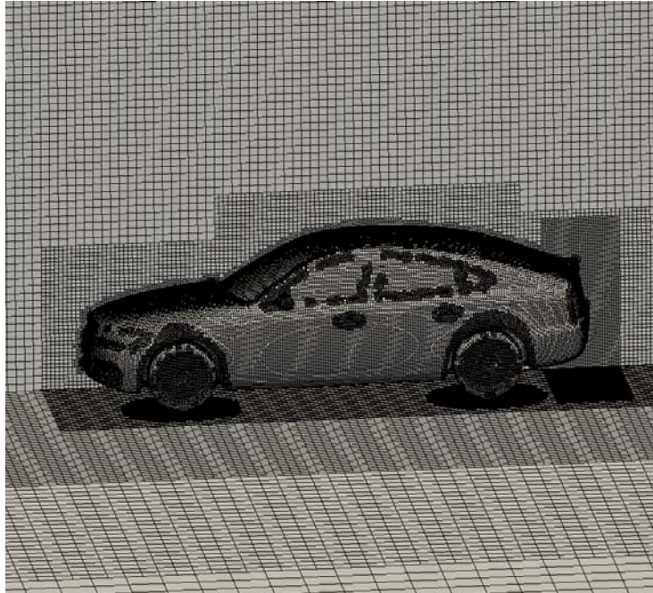
Σχήμα 2.9: Πλέγμα γύρω από τη διαμόρφωση Fastback .
