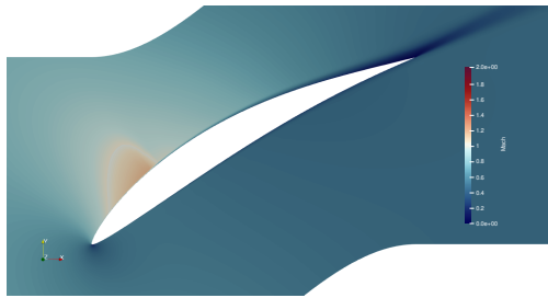
Σχήμα 5.26: Συγκριτικό Mach της ροής στη περύγωση πριν τη βελ/ση
