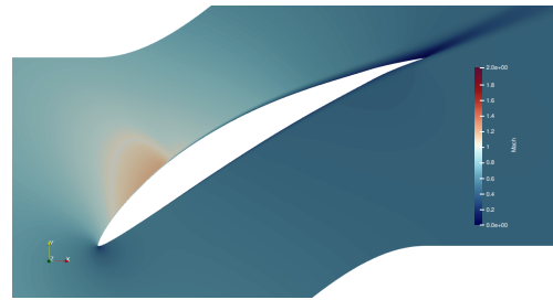
Σχήμα 5.27: Συγκριτικό Mach της ροής στη περύγωση μετά τη βελ/ση
