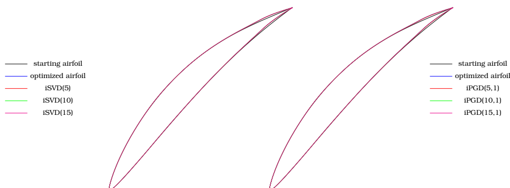
Σχήμα 5.24: Βελτιστοποιημένη αεροτομή συμπίεστή για μέγιστη άνωση μετά από 6 κύκλους με iSVD(k) και iPGD(M,1)
