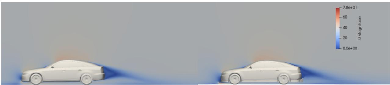
Σχήμα 3.1: Το πεδίο του μέτρου της ταχύτητας στο επίπεδο συμμετρίας για το πρωτότυπο όχημα (αριστερά) και για το όχημα με τις μετατροπές (δεξιά).
