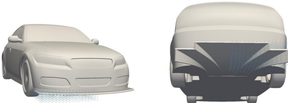
Σχήμα 5.1: Τα σημεία ελέγχου στον εμπρός splitter (αριστερά) και στον πίσω διαχύτη (δεξιά).
