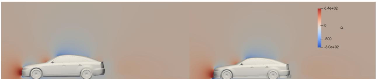
Σχήμα 3.2: Το πεδίο της πίεσης στο επίπεδο συμμετρίας για το πρωτότυπο όχημα (αριστερά) και για το όχημα με τις μετατροπές (δεξιά).
