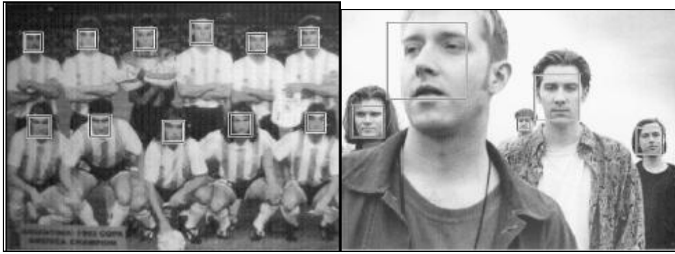
Σχήμα 3: Στις παραπάνω εικόνες, που δόθηκαν στον εκπαιδευμένο SVM στη φάση της δοκιμής του, έχουν ανιχνευθεί επιτυχώς τα ανθρώπινα πρόσωπα που περιέχονται σε αυτές, και έχουν περικλειστεί από ένα τετράγωνο.
