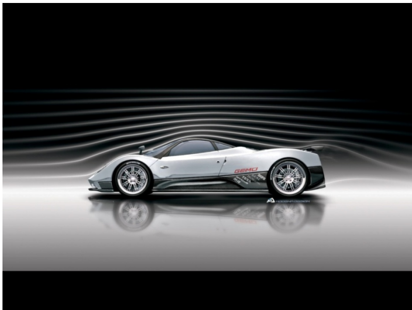
Σχήμα 1. Ακόμη και στο συγκεκριμένο αυτοκίνητο υψηλών επιδόσεων είναι εμφανές ότι στην απότομη μεταβολή της γεωμετρίας στο πίσω μέρος, οι γραμμές ροής δεν ακολουθούν επακριβώς το σχήμα του οχήματος και εμφανίζεται περιοχή ανακυκλοφορίας του ρευστού. (Πηγή: wonderwheelsng.net)
