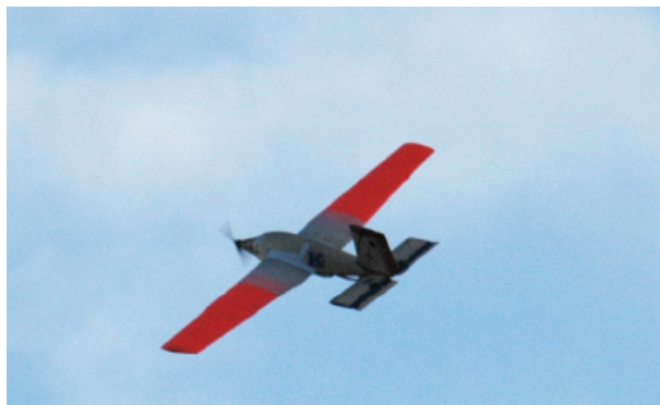
Σχήμα 1.2: Αεροσκάφος UAV που πετά με φουσκωτές πτέρυγες,[1]
