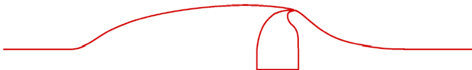
Σχήμα 1.17: Η γεωμετρία της εξεταζόμενης διαμόρφωσης. Εκτός από το προφίλ του σώματος Glauert-Goldschmied διακρίνεται και το χωρίο τοποθέτησης της σύνθετης δέσμης [16].
