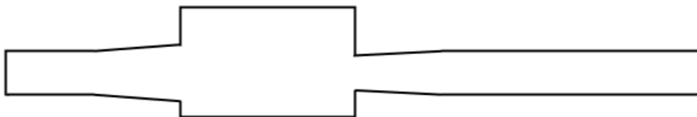
Σχήμα 2.1: Περίγραμμα γεωμετρίας της διαφραγματικής αντλίας. Στα αριστερά είναι η είσοδος της διάταξης και στα δεξιά η έξοδος της. Το άνω τμήμα του ορθογώνιου χωρίου είναι ελαστική μεμβράνη.
