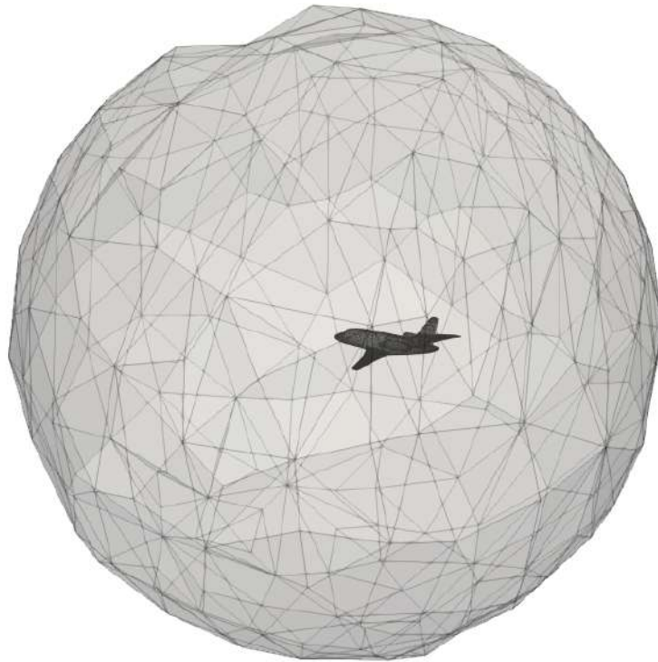
Σχήμα 5.12: 3D πλέγμα γύρω από ολόκληρο επιβατικό αεροσκάφος. Το υπολογιστικό χωρίο γύρω από το αεροσκάφος.
