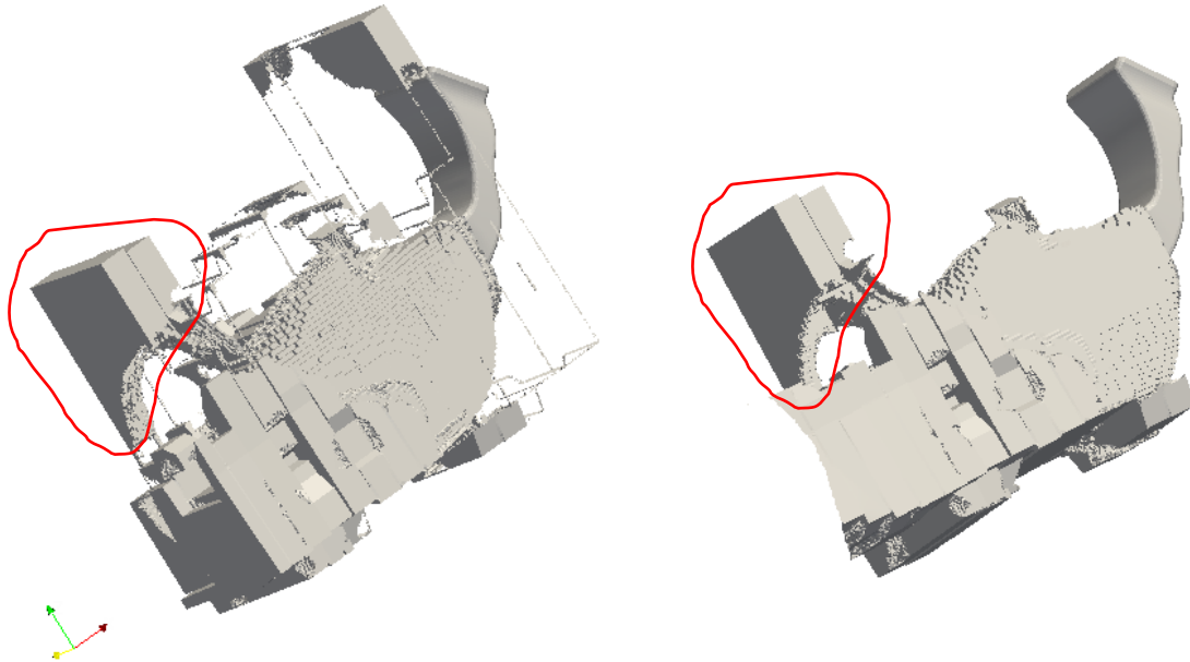
Σχ. 4.5. Λεπτομέρεια του αεραγωγού κοντά στον αγωγό εξόδου πριν (αριστερά) και μετά (δεξιά) την εφαρμογή του κώδικα απομόνωσης του βέλτιστου καναλιού ροής. Φαίνεται καθαρά η διαφορά μετά το «σκούπισμα» των περιττών κελιών αν και, περιοχές που θα έπρεπε επίσης να έχουν εξαφανιστεί, παραμένουν (π.χ. εντός της κόκκινης επισήμανσης).
