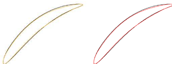
Σχήμα 8.13: Περίπτωση συμπίεστη: Η βέλτιστη αεροτομή με το BND_A (δεξιά) και με το BND_B (αριστερά).
