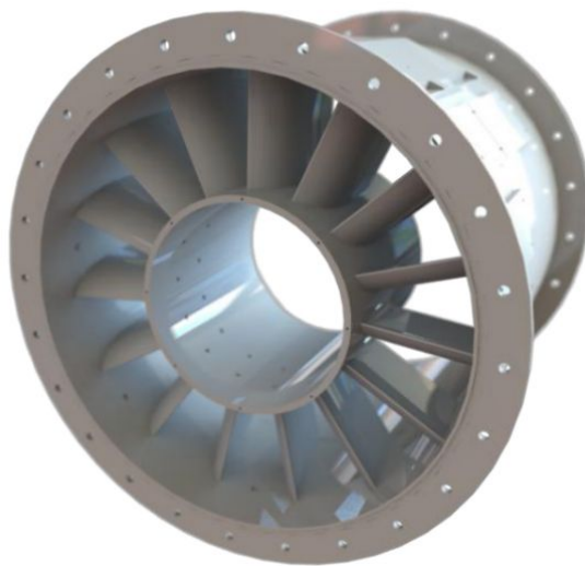
Σχήμα 5.1: Σταθερή πτερύγωση συμπίεστή TU Berlin: Τριδιάστατη απεικόνιση.
