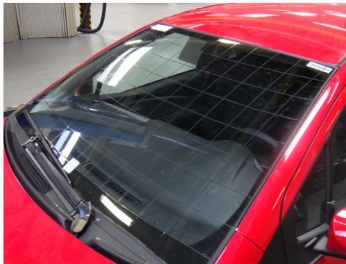
(α') Πλέγμα της μέτρησης από την εσωτερική πλευρά.
