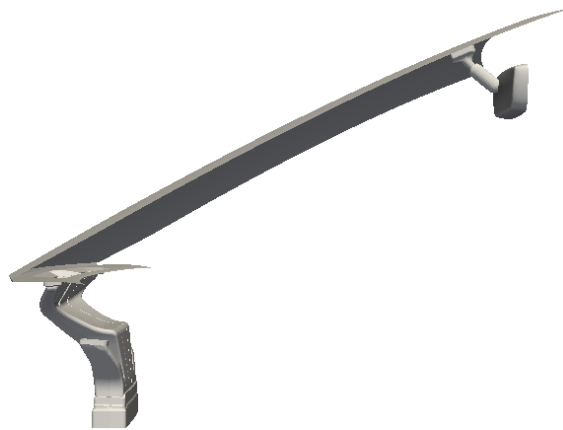
Σχήμα 4.2: Δεδομένα CAD για τα σημαντικά μέρη του μοντέλου: αγωγός αποπαγοποίησης, ανεμοθώρακας, ταμπλό κοντά στην έξοδο του αγωγού, καθρέπτης.
