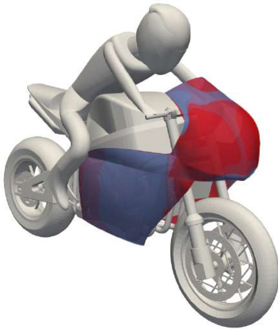
(α') Πλάγια-εμπρός όψη της μοτοσυκλέτας με τη διαφορά αρχικού και τελικού fairing.
