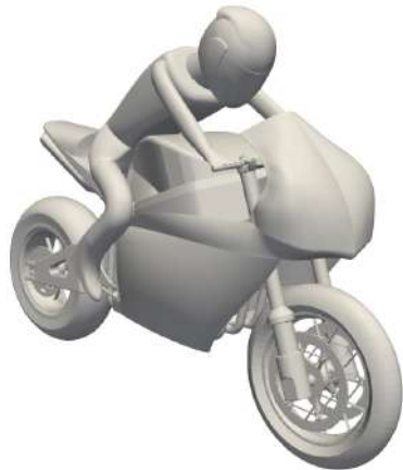
(α') Πλάγια-εμπρός όψη της μοτοσυκλέτας που προέκυψε από τη βελτιστοποίηση του εμπρός τμήματος του fairing.
