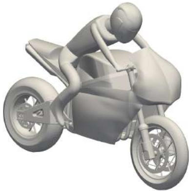
(γ') Πλάγια-εμπρός όψη της μοτοσυκλέτας που προέκυψε από τη βελτιστοποίηση ολόκληρου του fairing.
