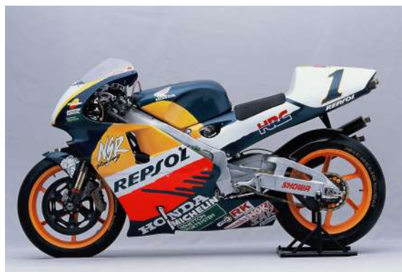
(β') Honda NSR500, Διχρόνος τετρακύλινδρος κινητήρας 500\text{ cm}^3 , 1984-2002.
