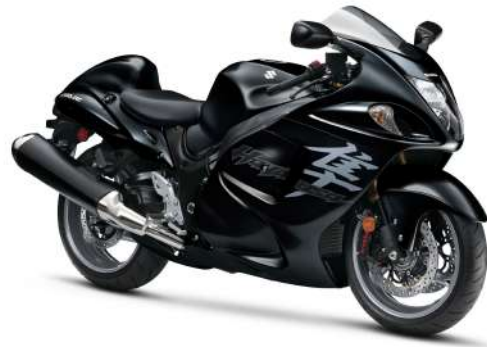
(β') Suzuki GSX1300R Hayabusa , Τετράχρονος τετρακύλινδος κινητήρας 1300 cm 3 , 1999-Σήμερα.
