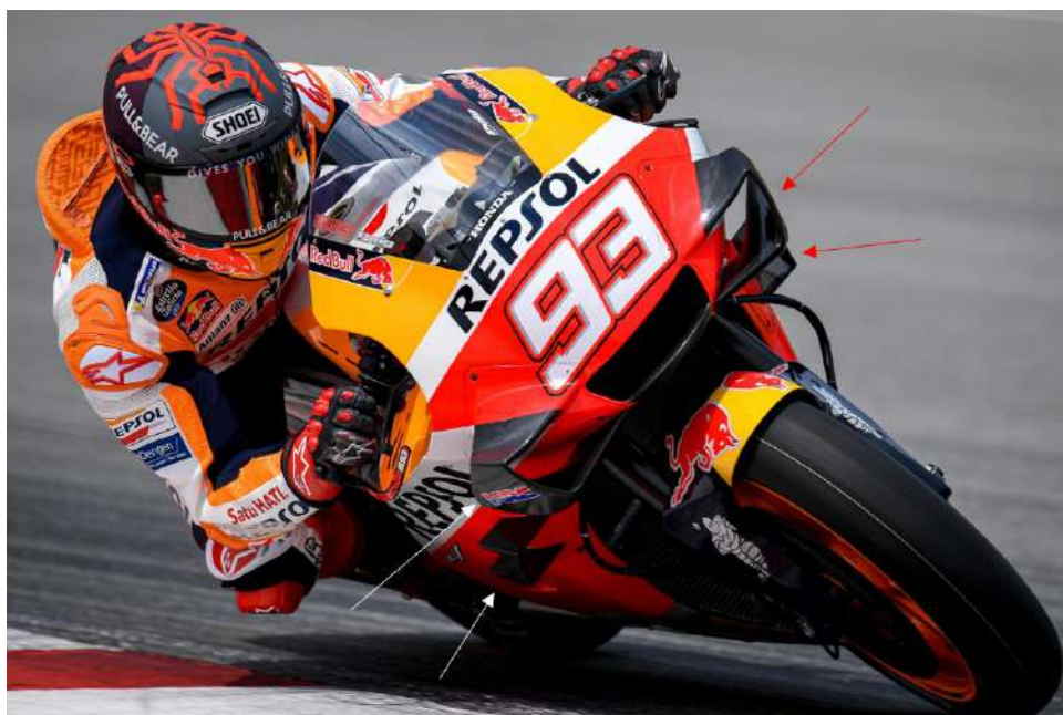
(γ') Honda RC213V, Τετράχρονος τετρακύλινδρος κινητήρας 1000\text{ cm}^3 , 2012-Σήμερα. Τα αεροδυναμικά βοηθήματα διευκρινίζονται με τα βέλη.
