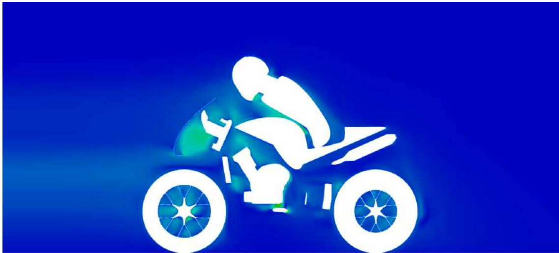
(α') Η συζυγής πίεση στο επίπεδο συμμετρίας.
