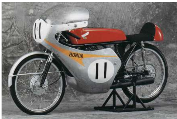
(α') Honda RC110, Τετράχρονος μονοκύλινδρος κινητήρας 50\text{ cm}^3 , 1961-1962.
