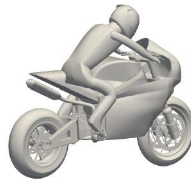
(δ') Πλάγια-πίσω όψη της μοτοσυκλέτας που προέκυψε από τη βελτιστοποίηση ολόκληρου του fairing.
