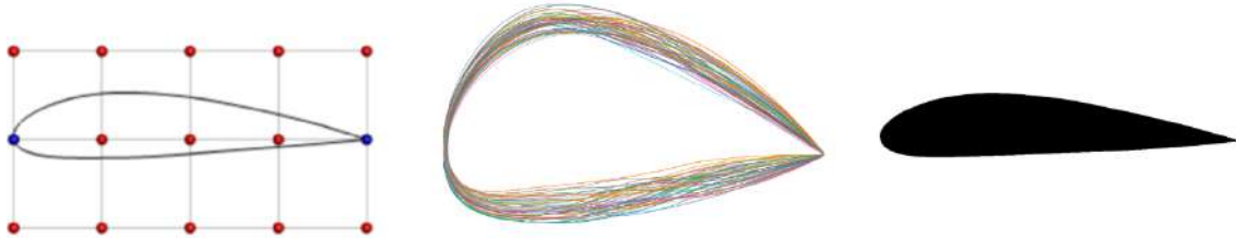
Σχήμα 2: (αριστερά) Το πλέγμα ελέγχου που περικλείει την αρχική γεωμετρία της μεμονωμένης αεροτομής NACA4318, και τα ΣΕ που το απαρτίζουν. (κέντρο) Τα περιγράμματα των διάφορων παραλλαγών της αρχικής αεροτομής που κατασκευάστηκαν. (δεξιά) Ένα τυχαίο δείγμα του συνόλου δεδομένων εισόδου, στην μορφή που θα εισέλθει στα νευρωνικά δίκτυα της παρούσας μελέτης.
