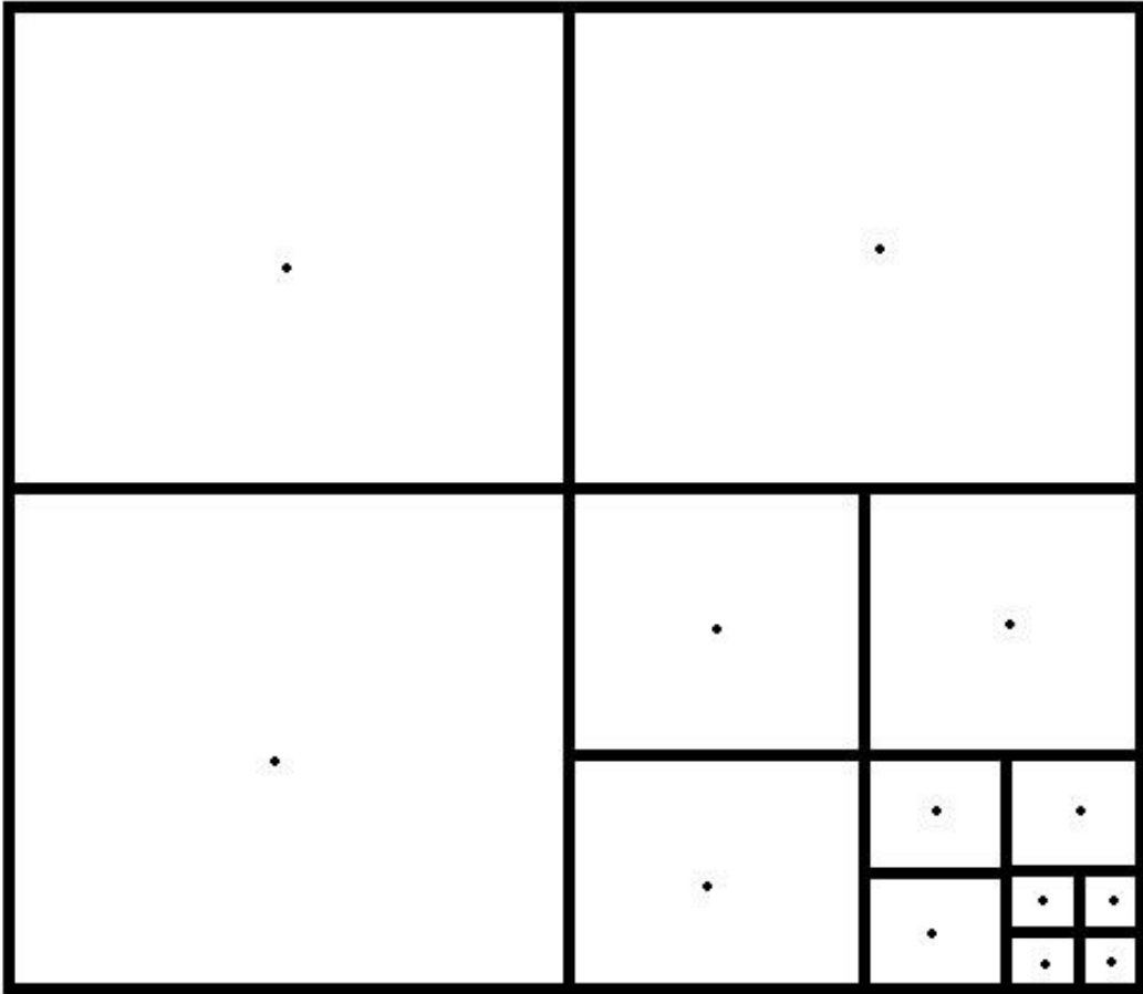
Σχήμα 2.7: Το υπολογιστικό χωρίο έτσι όπως έχει σχηματιστεί με τη μέθοδο τεμνόμενων κυψελών.
