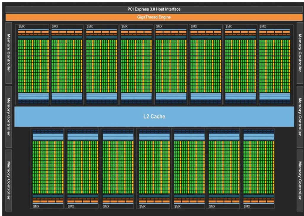
Σχήμα 3.4: Σχεδιάγραμμα της αρχιτεκτονικής Kepler. Σε αυτή, 15 πολυεπεξεργαστές μοιράζονται την ίδια L2 cache που επιταχύνει την προσπέλαση της κεντρικής μνήμης της κάρτας γραφικών και της τοπικής ανά thread που βρίσκεται στον ίδιο χώρο. Ο διάυλος επικοινωνίας (PCI Express 3.0 Host Interface) επιτρέπει τη μεταφορά δεδομένων από την κεντρική μνήμη της κάρτας γραφικών σε εκείνη του υπολογιστή και ανάποδα. Μια ειδική μονάδα (GigaThread) διανέμει τα blocks στους διαθέσιμους πολυεπεξεργαστές. Κάθε πολυεπεξεργαστής έχει 192 πυρήνες, 32 ειδικές μονάδες εκτέλεσης μαθηματικών συναρτήσεων, 4 μονάδες χειρισμού των warps, registers των 32-bit και 64KB shared και L1 cache. [21]
